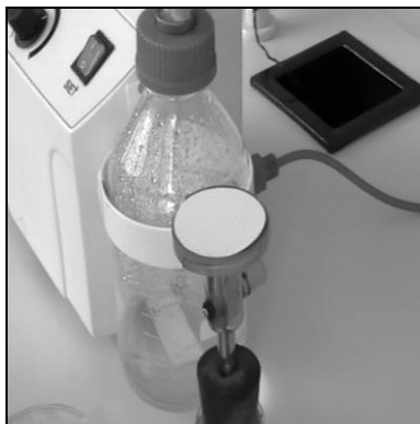
Obr. 16: Umístění filtru do filtrační aparatury.
