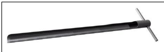
Obr. 1: Vzorkovač na pevné a pastovité materiály.
