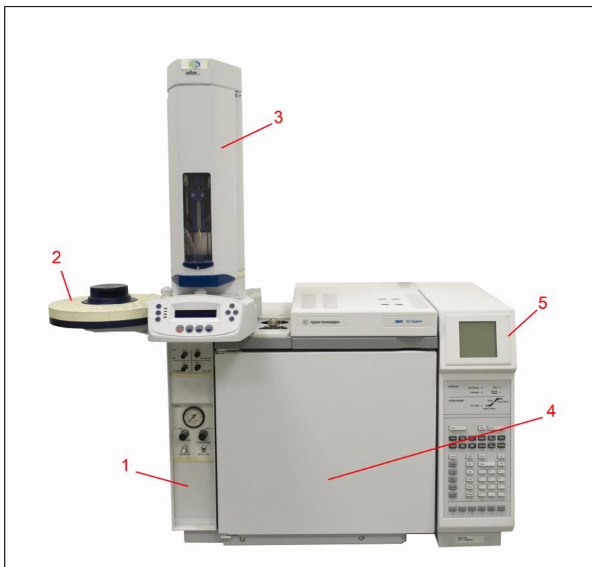
Obr 54: Agilent 6820 Gas Chromatograph System, Agilent Technologies Inc.: (1) regulační zařízení; (2) otočný karusel se vzorky; (3) injektor; (4) termostat s kolonou uvnitř; (5) detektor FID; (6) vyhodnocovací zařízení
