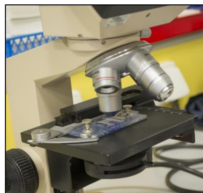
Obr 50: Mikroskopické stanovení počtu nálevníků
