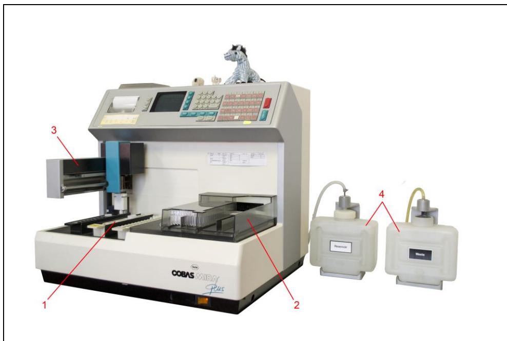
Obr 64: Biochemický analyzátoř Cobas Mira Plus, Roche: (1) prostor pro reagentie, vzorky, kalibrátory, kontroly a mycí roztok - promývací roztok: Mucasol (Merz); (2) kruhový prostor pro reakční kvety doplněný vlastní fotometrickou jednotkou (teplota v kvetách je udržována na 37 °C); (3) dávkovací rameno s jehlou - jehla obsahuje čidlo ve funkci hladinového senzoru (minimální reakční objem 100 µl); (4) nádoba s destilovanou vodou a odpad
