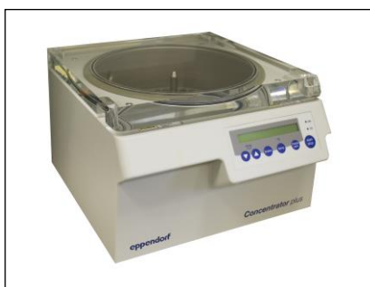
Obr 34: Odpaření vzorku do sucha
