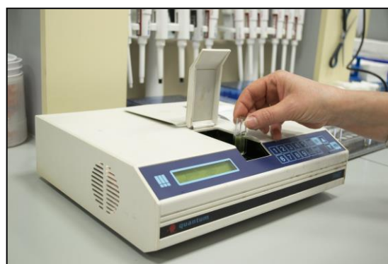
Obr 48: Fotometrické stanovení koncentrace amoniaku
